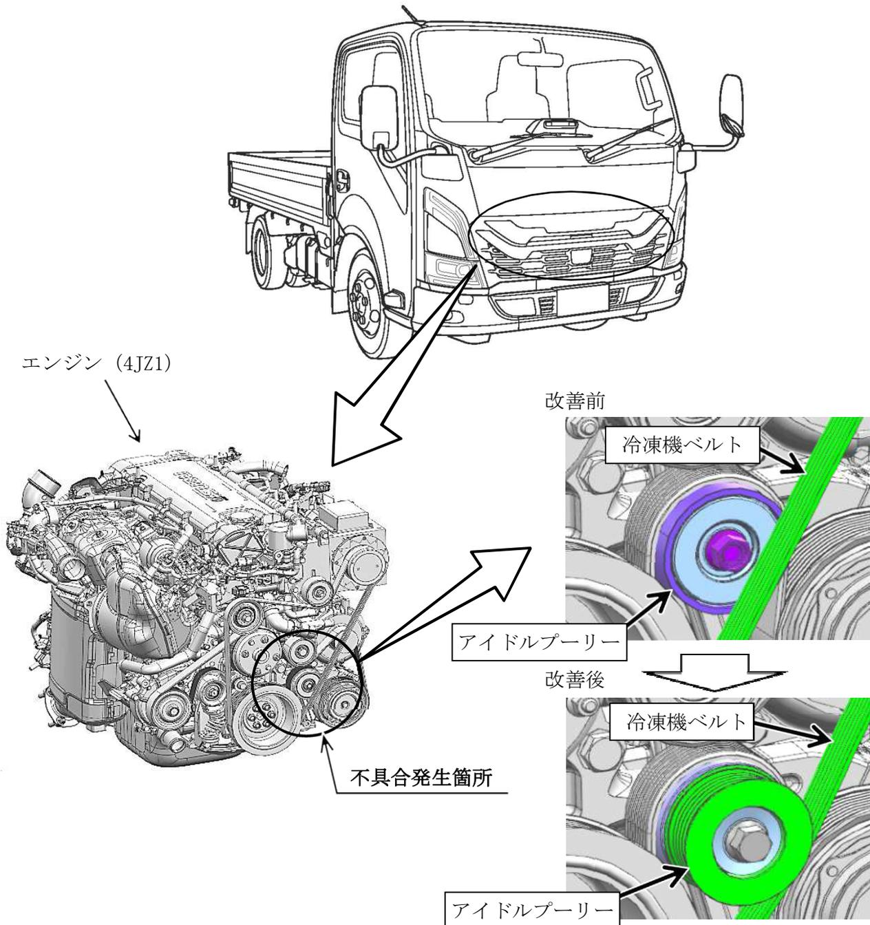
冷凍機架装車のアイドルプーリーにおいて、部品選択が不適切なため、当該アイドルプーリーと冷凍機用ベルトが干渉することがある。そのため、冷凍機用ベルトが損傷し、最悪の場合、ベルト外れや破断により冷凍機が停止するおそれがある。
